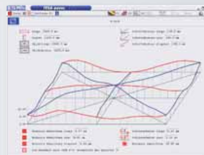
Измерение гранитной плиты согласно U-Jack
